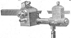
Neuester doppelter Gewindedrehstahlhalter, patentiert in allen Staaten.
