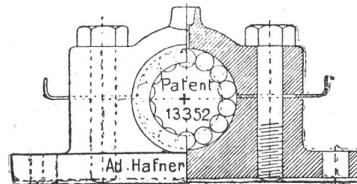
Diese einfachsten aller Kugellager können bei den meisten Maschinen und Transmissionen etc. mit dem grössten Vorteil verwendet
