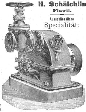
Hochdruck-Turbinen, Turbinen für alle Gefälle und Wassermengen.
