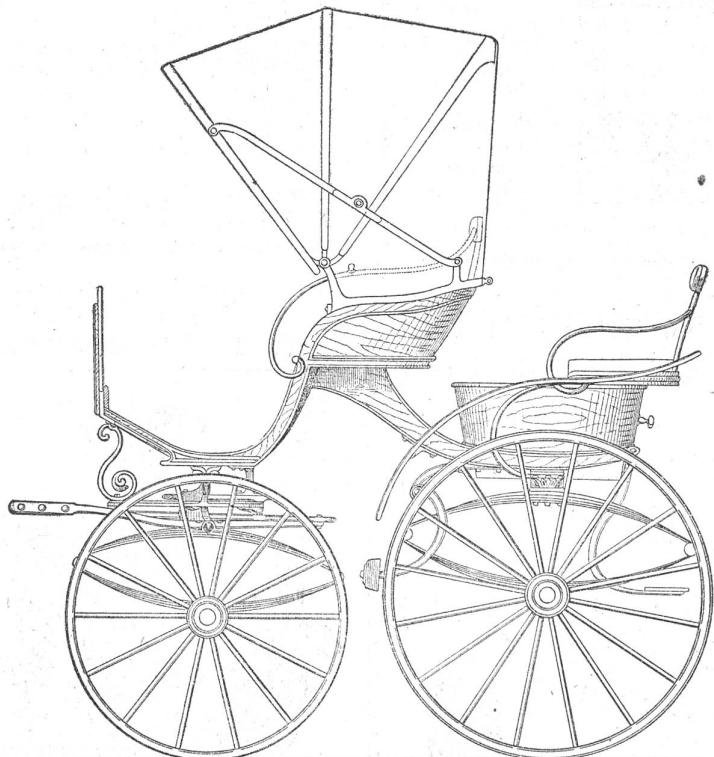
Um das Chaischen in einen vierplätzigen Break umzuwandeln, ist das Kästchen auf den Hinterwagen zu stellen und mit zwei Schrauben an der Federn-Traverse zu befestigen, welches ein Mann in 1—2 Minuten bewerkstelligen kann.
