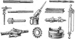
Gewindeschneidzeuge für Gas-, Whitworth-, Bodmer- und Löwenherzgewinde mit schrägen oder Reinecker-Patent-Kluppen.
