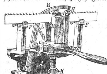
Dieser höchst einfache Apparat besitzt den Hauptvorteil, daß mit demselben jedes Sägeblatt beliebig weit oder eng geschränkt werden kann und zudem der Arbeiter auch sieht, wie der Apparat arbeitet. Die arbeitenden Teile desselben sind aus gehärtetem Stahl verfertigt, so daß eine Abnutzung ausgeschlossen ist.
