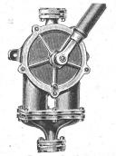
Neue doppelwirkende Kolbenpumpe
