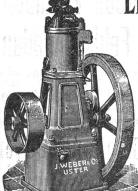
(System Capitaine). Vorzügliche, gut durch-dachte Konstruktion, in über 4000 Exemplaren verbreitet. Inbetriebsetzung innert 8 Minuten. Petrolverbrauch nur 1/2 Liter per Pferdekraftstunde. — Beste Verbrennung der Gase, daher gering-ster Geruch. Ruhiger, gleich-mässiger Gang. Solider Bau. Billigste Betriebskraft. [108
