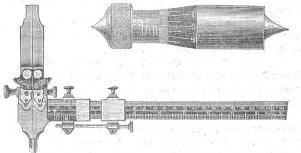
Gewindeschneidzeuge für Gas-, Whitworth-, Bodmer- und Löwenherzgewinde mit schrägen oder Reinecker-Patent-Kluppen.
