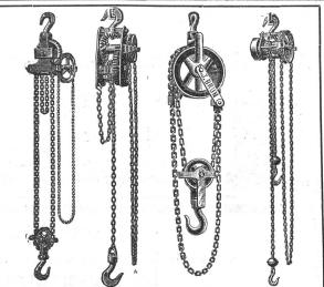
Flaschenzüge, Winden. Wellenböcke, Krahnen, Ketten u. Kettenräder
