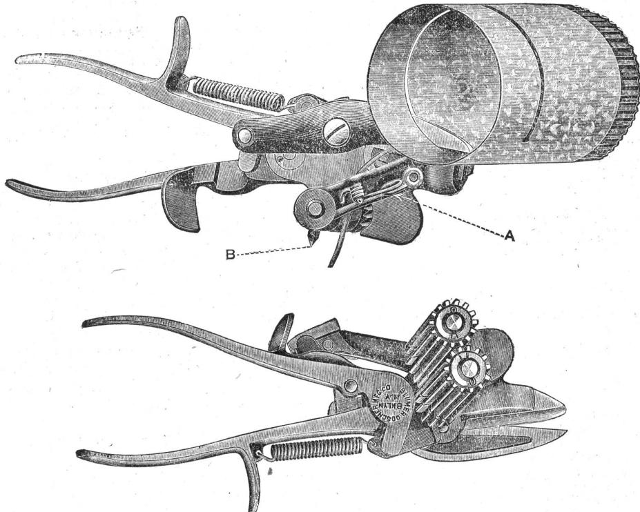
vereinigt verschiedene Werkzeuge in einem. Alle Arten von Metallröhren lassen sich nicht nur in jeder beliebigen Richtung und an jedem beliebigen Punkt durchschneiden, sondern es können die Röhren auch sofort mit Leichtigkeit und ohne diese irgendwie zu beschädigen, durch eine höchst sinnreiche Vorrichtung eingezogen oder enger gemacht werden.
