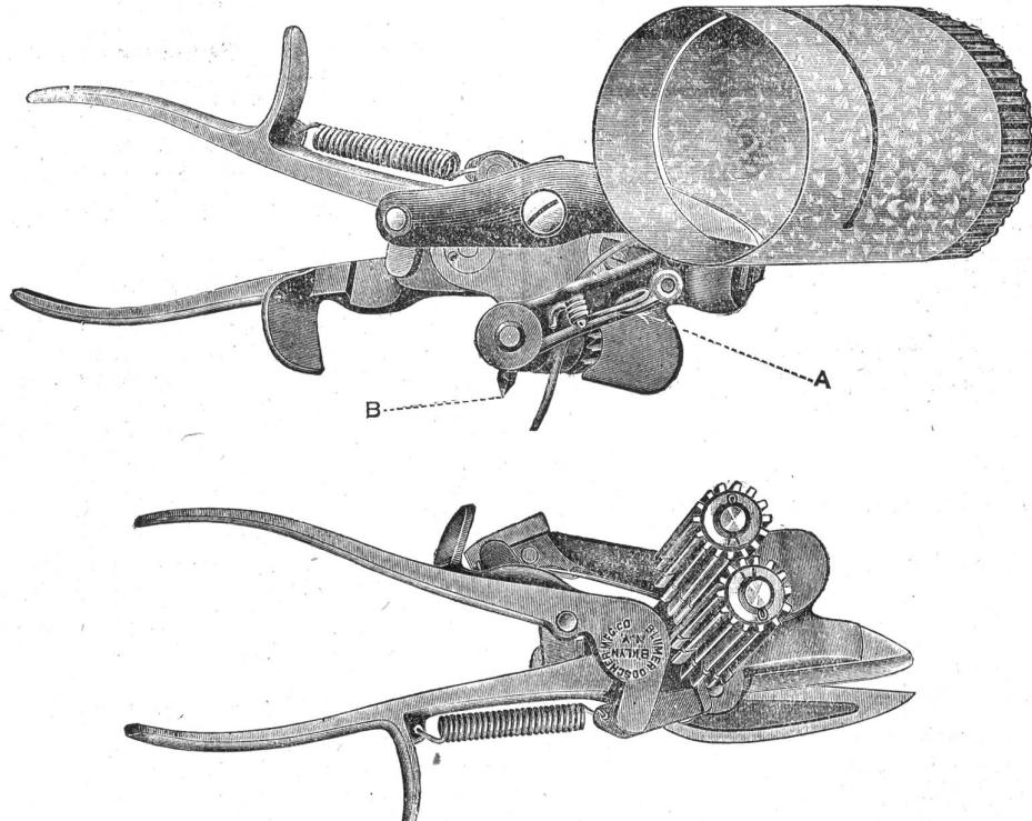
vereinigt verschiedene Werkzeuge in einem. Alle Arten von Metallröhren lassen sich nicht nur in jeder beliebigen Richtung und an jedem beliebigen Punkt durchschneiden, sondern es können die Röhren auch sofort mit Leichtigkeit und ohne diese irgendwie zu beschädigen, durch eine höchst sinnreiche Vorrichtung eingezogen oder enger gemacht werden.
