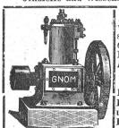
Unbedingt zuverlässiger und ruhiger Gang. Betrieb mit ge-wöhnlichem Lampenpetroleum (kein Benzin). Schmierung durchaus selbstthätig ohne Schmiergefässe, daher wenig Wartung, grosse Oelersparnis. Grösste Dauerhaftigkeit, einfachste Konstruktion. Konsum der Petroleum-Motoren eirea 0,4 bis 0,6 Liter gewöhn-liches billiges Lampenpetroleum pro Pferdekraft und Stunde.
