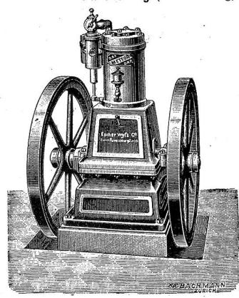
„Meteor“ System Escher Wyss & Cie, stehende und liegende Anordnung von 1 bis 25 HP und mehr. einfache Konstruktion, solider Bau, geräuschosloser Gang, höchste Leistungsfähigkeit, minimaler Petroleumverbrauch; für Landwirtschaft, Gewerbe, Industrie, elektrisches Licht. — Weitgehendste Garantien. [1209c]
