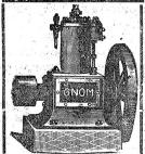
Unbedingt zuverlässiger und ruhiger Gang. Betrieb mit gewöhnlichem Lampenpetroleum (kein Benzin). Schmierung durchaus Selbsthätig ohne Schmiergefässe, daher wenig Wartung, grosse Oelersparnis. Grösste Dauerhaftigkeit, einfachste Konstruktion. Konsum der Petroleum-Motoren circa 0,4 bis 0,6 Liter gewöhnliches billiges Lampenpetroleum pro Pferdekraft und Stunde.
