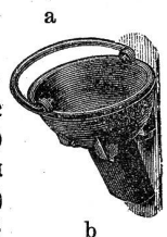
Wärme-Gestell für gewöhnliche Löt Kolben mit Löt Lampe La K H L L.
