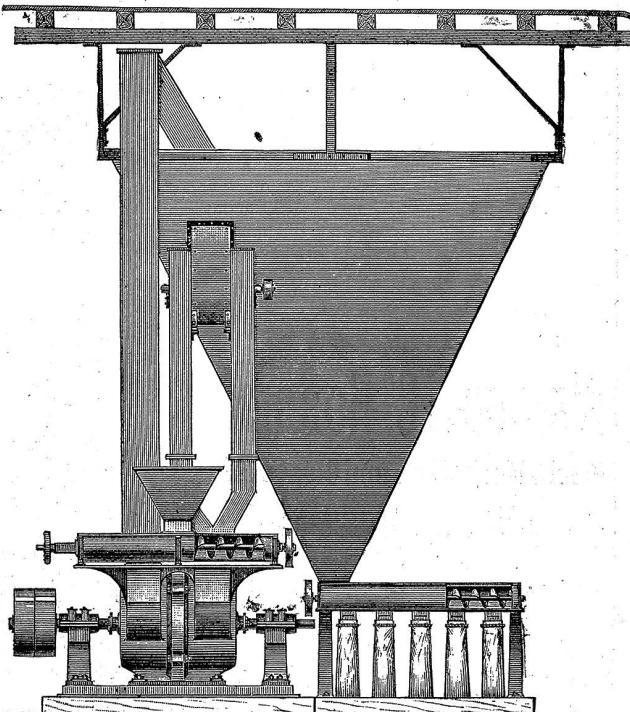
Die Exhaustor-Mühle ist außerordentlich einfach, die arbeitenden Teile sind sehr stabil aus zähem Stahl hergestellt, die Abnutzung ist erfahrungsmäßig so gut wie Null. Der Exhaustor saugt den Staub ununterbrochen aus der Mühle ab und führt ihn nach der eigens konstruierten Mehlmutter aus welcher er nach Belieben entnommen werden kann.
