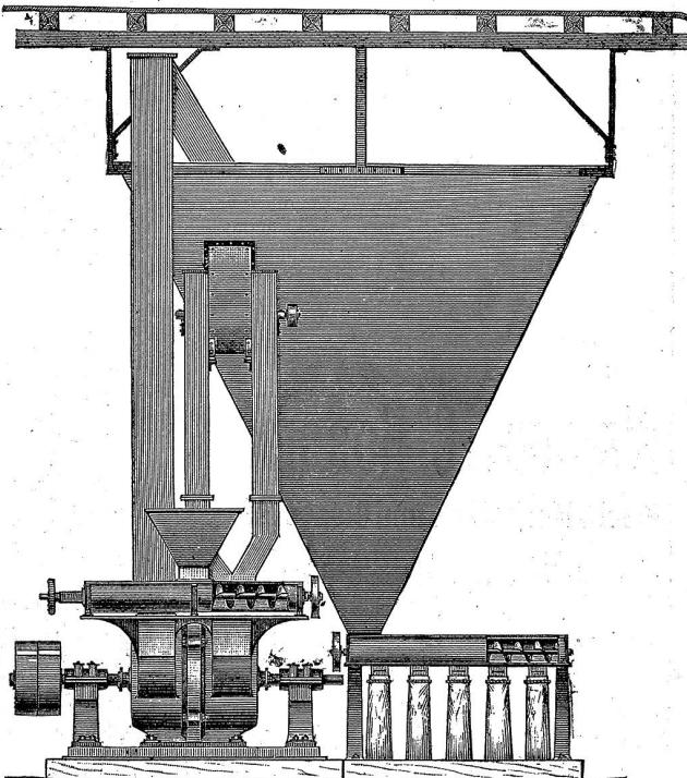
Die Exhaustor-Mühle ist außerordentlich einfach, die arbeitenden Teile sind sehr stabil aus zähem Stahl hergestellt, die Abnutzung ist erfahrungsmäßig so gut wie Null. Der Exhaustor saugt den Staub ununterbrochen aus der Mühle ab und führt ihn nach der eigens konstruierten Mehlmutter aus welcher er nach Belieben entnommen werden kann.
