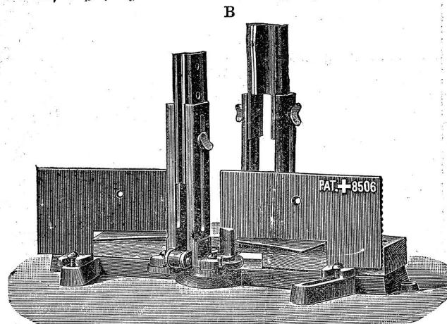
Vorstehende Abbildung B zeigt das sehr praktische Verstellen der Anschlagwände nach hinten für faconierte, ovale resp. geschweifte Stücke, wodurch jede Gehrung derselben leicht gemacht werden kann.
