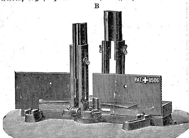
Worsthende Abbildung B zeigt das sehr praktische Verstellen der Anschlagwände nach hinten für faconierte, ovale resp. geschweifte Stücke, wodurch jede Gehrung derselben leicht gemacht werden kann.
