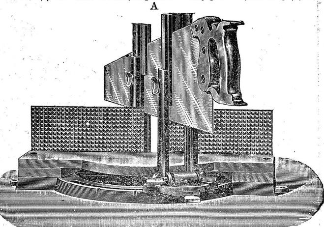
Durch diese höchst einfache und schnelle Verstellung kann man in der Gehrung von 45° noch 18–20 cm breit schneiden, was bisher mit einer einfachen Gehrungssäge unmöglich war.
