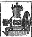
Unbedingt zuverlässiger und ruhiger Gang. Betrieb mit gewöhnlichem Lampenpetroleum (kein Benzin). Schmierung durchaus selbstthätig ohne Schmiergefässe, daher wenig Wartung, grosse Oelersparnis. Grösste Dauerhattigkeit, einfachste Konstruktion. Konsum der Petroleum-Motoren eirca 0,4 bis 0,6 Liter gewöhn-liches billiges Lampenpetroleum pro Pferdekraft und Stunde.
