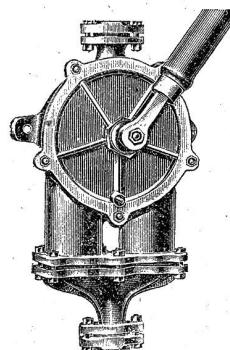
**Neue doppelwirkende Kolbenpumpe**
