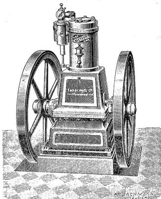
„Meteor“ System Escher Wyss & Cie. Stehende und liegende Anordnung von 1 bis 25 HP und mehr. Einfache Konstruktion, solider Bau, geräuscharmer Gang, höchste Leistungsfähigkeit, minimaler Petroleumverbrauch; für Landwirtschaft, Gewerbe, Industrie, elektrisches Licht. — Weitgehendste Garantien. [1209c]
