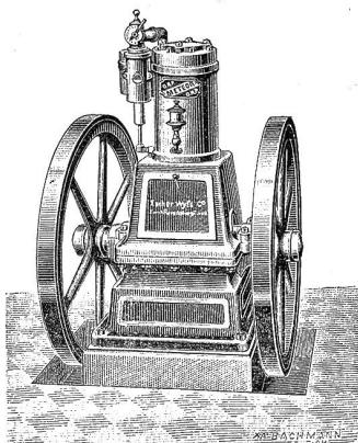
„Meteor“ System Escher Wyss & Cie. Stehende und liegende Anordnung von 1 bis 25 HP und mehr. Einfache Konstruktion, solider Bau, geräuschloser Gang, höchste Leistungsfähigkeit, minimaler Petroleumverbrauch; für Landwirtschaft, Gewerbe, Industrie, elektrisches Licht. — Weitgehendste Garantien. [1209c]
