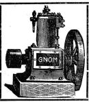
Unbedingt zuverlässiger und ruhiger Gang. Betrieb mit gewöhnlichem Lampenpetroleum (kein Benzin). Schmierung durchaus selbstthätig ohne Schmiergefässe, daher wenig Wartung, grosse Oelersparnis. Grösste Dauerhaftigkeit, einfachste Konstruktion. Konsum der Petroleum-Motoren circa 0,4 bis 0,6 Liter gewöhnliches billiges Lampenpetroleum pro Pferdekraft und Stunde.
