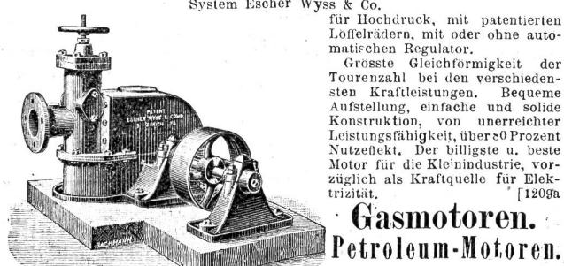
für Hochdruck, mit patentierten Löffelräder, mit oder ohne automatischen Regulator.
