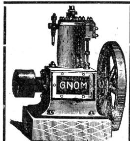
Unbedingt zuverlässiger und ruhiger Gang. Betrieb mit gewöhnlichem Lampenpetroleum (kein Benzin). Schmierung durchaus selbsttätig ohne Schmiergefässe, daher wenig Wartung, grosse Oelersparnis. Grösste Dauerhaftigkeit, einfachste Konstruktion. Konsum der Petroleum-Motoren circa 0,4 bis 0,6 Liter gewöhnliches billiges Lampenpetroleum pro Pferdekraft und Stunde.
