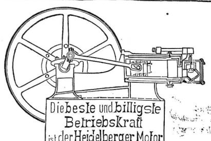
Betrieb mit Gas Benzin, Ligroin, Petroleum oder Solaröl.
