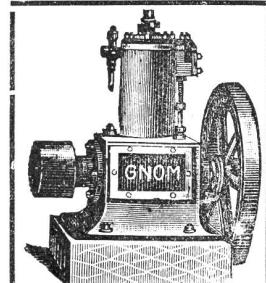
Unbedingt zuverlässiger und ruhiger Gang. Betrieb mit gewöhnlichem Lampenpetroleum (kein Benzin). Schmierung durchaus selbsttätig ohne Schmiergefässe, daher wenig Wartung, grosse Oelersparnis. Grösste Dauerhaftigkeit, einfachste Konstruktion. Konsum der Petroleum-Motoren circa 0,4 bis 0,6 Liter gewöhnliches billiges Lampenpetroleum pro Pferdekraft und Stunde.
