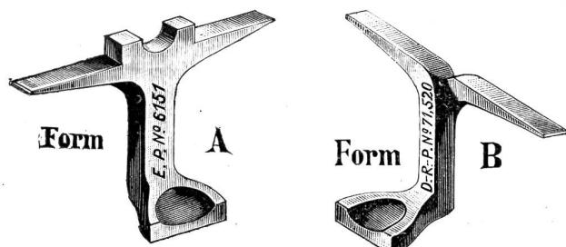
Müssen die Bretter satt schließen (z. B. bei Fabrikboden, Dachverschalungen, Holz cement dächern, horizontalen und vertikalen Verbretterungen, wobei „Form B“ zu verwenden ist), so wird der vorstehende Steg mit Hülfe eines auf denselben gehaltenen Seizeitens vermittelst des Hammers vollständig in das erste Brett eingeschlagen; nur bei ganz hartem Holz ist es notwendig, den Steg des Häftens durch einen Kerbenschliff einzulassen.
