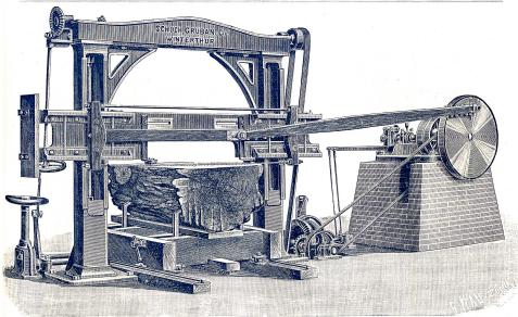
Patent-Horizontalgatter mit einem Vorschub bis zu drei Meter per Minute. Patent Doppelsägerahmen. Scieries horizontales brevetées. Aménage jusqu'à trois mètres par minute. Châssis breveté pour deux lames.
