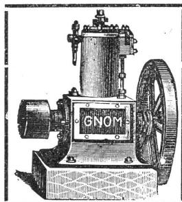
Unbedingt zuverlässiger und ruhiger Gang. Betrieb mit gewöhnlichem Lampenpetroleum (kein Benzin). Schmierung durchaus selbstthätig ohne Schmiergefässe, daher wenig Wartung, grosse Oelersparnis. Grösste Dauerhaftigkeit, einfachste Konstruktion. Konsum der Petroleum-Motoren circa 0,4 bis 0,6 Liter gewöhnliches billiges Lampenpetroleum pro Pferdekraft und Stunde.
