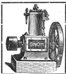
Unbedingt zuverlässiger und ruhiger Gang. Betrieb mit gewöhnlichem Lampenpetroleum (kein Benzin). Schmierung durchaus selbstthätig ohne Schmiergefässe, daher wenig Wartung, grosse Oelersparnis. Grösste Dauerhaftigkeit, ein'achste Konstruktion. Konsum der Petroleum-Motoren eirea 0,4 bis 0,6 Liter gewöhn-liches billiges Lampenpetroleum pro Pferdekraft und Stunde.
