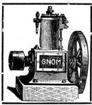
Unbedingt zuverlässiger und ruhiger Gang. Betrieb mit gewöhnlichem Lampenpetroleum (kein Benzin). Schmierung durchaus selbstthätig ohne Schmiergefässe, daher wenig Wartung, grosse Oelersparnis. Grösste Dauerhaftigkeit, eintachste Konstruktion. Konsum der Petroleum-Motoren eirea 0,4 bis 0,6 Liter gewöhnliches billiges Lampenpetroleum pro Pferdekraft und Stunde.
