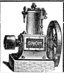
Unbedingt zuverlässiger und ruhiger Gang. Betrieb mit gewöhnlichem Lampenpetroleum (kein Benzin). Schmierung durchaus selbstthätig ohne Schmiergefässe, daher wenig Wartung, grosse Oelersparnis. Grösste Dauerhaftigkeit, einfachste Konstruktion. Konsum der Petroleum-Motoren circa 0,4 bis 0,6 Liter gewöhnliches billiges Lampenpetroleum pro Pferdektaft und Stunde.
