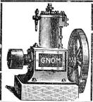
Unbedingt zuverlässiger und ruhiger Gang. Betrieb mit gewöhnlichem Lampenpetroleum (kein Benzin). Schmierung durchaus selbstthätig ohne Schmiergetässe. daher wenig Wartung, grosse Oelersparnis. Grösste Dauerhaftigkeit, ein achste Konstruktion. Konsum der Petroleum-Motoren circa 0.4 bis 0,6 Liter gewöhnliches billiges Lampenpetroleum pro Pferdekraft und Stunde.
