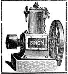
Unbedingt zuverlässiger und ruhiger Gang. Betrieb mit gewöhnlichem Lampenpetroleum (kein Benzin). Schmierung durchaus selbstthätig ohne Schmiergefässe, daher wenig Wartung, grosse Oelersparnis. Grösste Dauerhaftigkeit, einfachste Konstruktion. Konsum der Petroleum-Motoren eirea 0,4 bis 0,6 Liter gewöhn-tiches billiges Lampenpetroleum pro Pferdekraft und Stunde.
