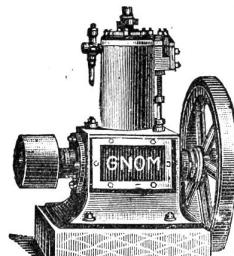
Unbedingt zuverlässiger und ruhiger Gang. Betrieb mit gewöhnlichem Lampenpetroleum (kein Benzin). Schmierung durchaus selbstthätig ohne Schmiergetässen, daher wenig Wartung, grosse Oelersparnis. Grösste Dauerhaftigkeit, einfachste Konstruktion. Konsum der Petroleum-Motoren circa 0,4 bis 0,6 Liter gewöhnliches billiges Lampenpetroleum pro Pferdekraft und Stunde.
