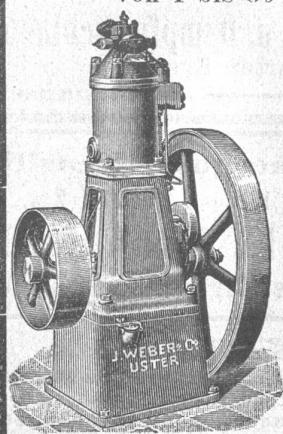
vorzüglichster, bewährtester Konstruktion (System Swiderski-Capitaine, patentiert). In mehr als 3000 Exempl. verbreitet, feststehend und fahrbar, (Lokomobile). Geringst. Petrolverbrauch, kürzeste Inbetriebsetzung, kleiner Raumbedarf, solider Bau. 85
