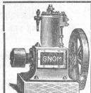
Unbedingt zuverlässiger und ruhiger Gang. Betrieb mit gewöhnlichem Lampenpetroleum (kein Benzin). Schmierung durchaus selbstthätig ohne Schmiergefässe, daher wenig Wartung, grosse Oelersparnis. Grösste Dauerhaftigkeit, einfachste Konstruktion. Konsum der Petroleum-Motoren eirca 0,4 bis 0,6 Liter gewöhn-liches billiges Lampenpetroleum pro Pferdeklaft und Stunde.
