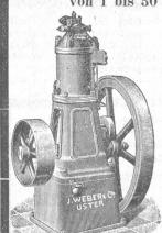
vorzüglicher, bewährtester Konstruktion (System Swiderski Capitaine, patentiert). In mehr als 3000 Exempl. verbreitet, feststehend und fahrbar, (Lokomobile). Geringst. Petroleumverbrauch, kürzeste Inbetriebsetzung, kleinster Raumbedarf, solider Ban.
