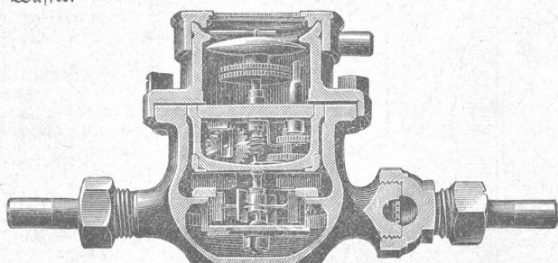
Durch geringe Änderungen in der Bauart des Meinecke'schen Patent-Kugel-Wassermessers kann dieser auch zum Messen anderer leicht beweglicher Flüssigkeiten, z. B. Petroleum etc., benutzt werden.
