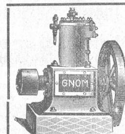
Unbedingt zuverlässiger und ruhiger Gang. Betrieb mit gewöhnlichem Lampenpetroleum (kein Benzin). Schmierung durchaus selbstthätig ohne Schmiergefäß, daher wenig Wartung, grosse Oelfersparnis. Grösste Dauerhaftigkeit, einfachste Konstruktion. Konsum der Petroleum-Motoren circa 0,4 bis 0,6 Liter gewöhnliches billiges Lampenpetroleum pro Pferdekraft und Stunde.
