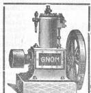
Unbedingt zuverlässiger und ruhiger Gang. Betrieb mit gewöhnlichem Lampenpetroleum (kein Benzin). Schmierung durchaus selbstthätig ohne Schmiergefässe, daher wenig Wartung, grosse Oelersparnis. Grösste Dauerhaftigkeit, einfachste Konstruktion. Konsum der Petroleum-Motoren circa 0,4 bis 0,6 Liter gewöhnliches billiges Lampenpetroleum pro Pferdekraft und Stunde.
