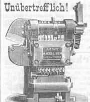
Für Hand- u. Motorenbetrieb. Ohne das Geringste ändern zu müssen, können nachstehende Arbeiten gemacht werden: Löcher in Eisendicken bis 10 mm von 4, 41'2, 5, 6, 7, 8, 9, 10 mm. Scheere für Flacheisen 10 auf 50 mm. Winkeleisen 35 mm, Rundeisen 15 mm.
