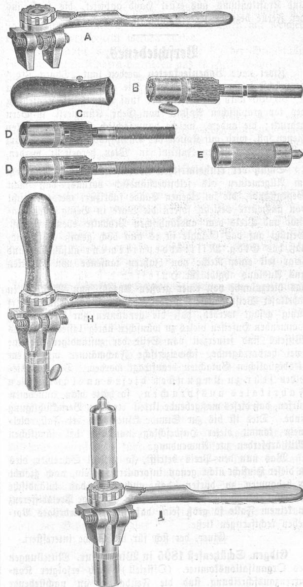
Will man die Hälfte „B“ in den Schlüssel montieren, so klemmt man solche mit den Backen des Schlüssels fest, befestigt an der oberen Verlängerung den Handgriff C und man erhält dadurch eine Holzbohrrätsche für Rechts- und Links-Drehung, wie Fig. H zeigt.
