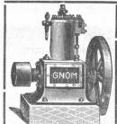
Unbedingt zuverlässiger und ruhiger Gang. Betrieb mit gewöhnlichem Lampenpetroleum (kein Benzin). Schmierung durchaus selbsthätig ohne Schmiergefässe. daher wenig Wartung, grosse Oelersparnis. Grösste Dauerhaftigkeit, einfachste Konstruktion. Konsum der Petroleum-Motoren eine 0,4 bis 0,6 Liter gewöhnliches billiges Lampenpetroleum pro Pferdekraft und Stunde.
