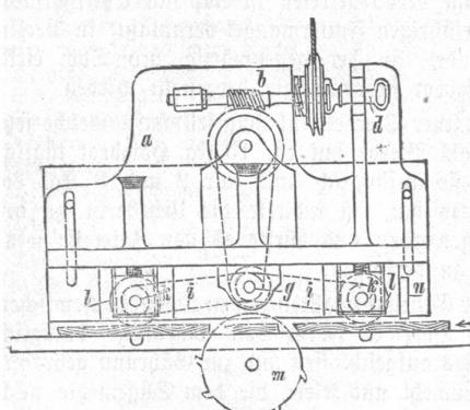
Eine Vorschub- und Schutzvorrichtung für Kreissägen ist Herrn Georg Penkl in München unter Nr. 77,249 patentiert worden.
