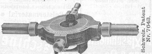
Schneidkluppen für Gasrohre neuester Konstruktion.
