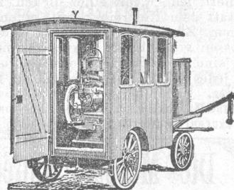
**Fahrbare Motoren zum Betrieb von Dresch-
