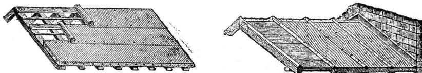
Längsdeckung ohne Verschalung. Leistendeckung m. Maueranschluss von Gebäuden jeder Art, besonders Fabriken, Schuppen, Hallen etc. Innere Bekleidung von Fabriken gegen Säure-Angriffe. Giebel-Bekleidung. 368] Unterdeckung von Wellblech-Dächern (gegen Tropfen) etc. etc. Proben und Prospekte zur Verfügung.
