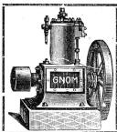
Unbedingt zuverlässiger und ruhiger Gang. Betrieb mit gewöhnlichem Lampenpetroleum (kein Benzin). Schmierung durchaus selbstthätig ohne Schmiergefässe, daher wenig Wartung, grosse Oelersparnis. Grösste Dauerhattigkeit, einfachste Konstruktion. Konsum der Petroleum Motoren eirca 0.4 bis 0,6 Liter gewöhnliches billiges Lampenpetroleum pro Pferdekraft und Stunde.
