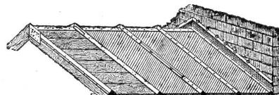
**Längsdeckung ohne Verschalung. Leistendeckung m. Maueranschluss von Gebäuden jeder Art, besonders Fabriken, Schuppen, Hallen etc.**
