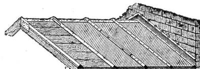
**Längsdeckung ohne Verschalung. Leistendeckung m. Maueranschluss von Gebäuden jeder Art, besonders Fabriken, Schuppen, Hallen etc.**
