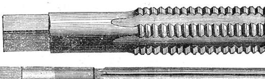
Schneidkluppen für Gasrohre neuester Konstruktion.
